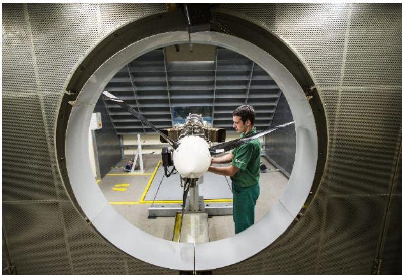
Obr.: Testování turbovrtulového motoru TJ 1P100 ve zkušebně letecké divize PBS
