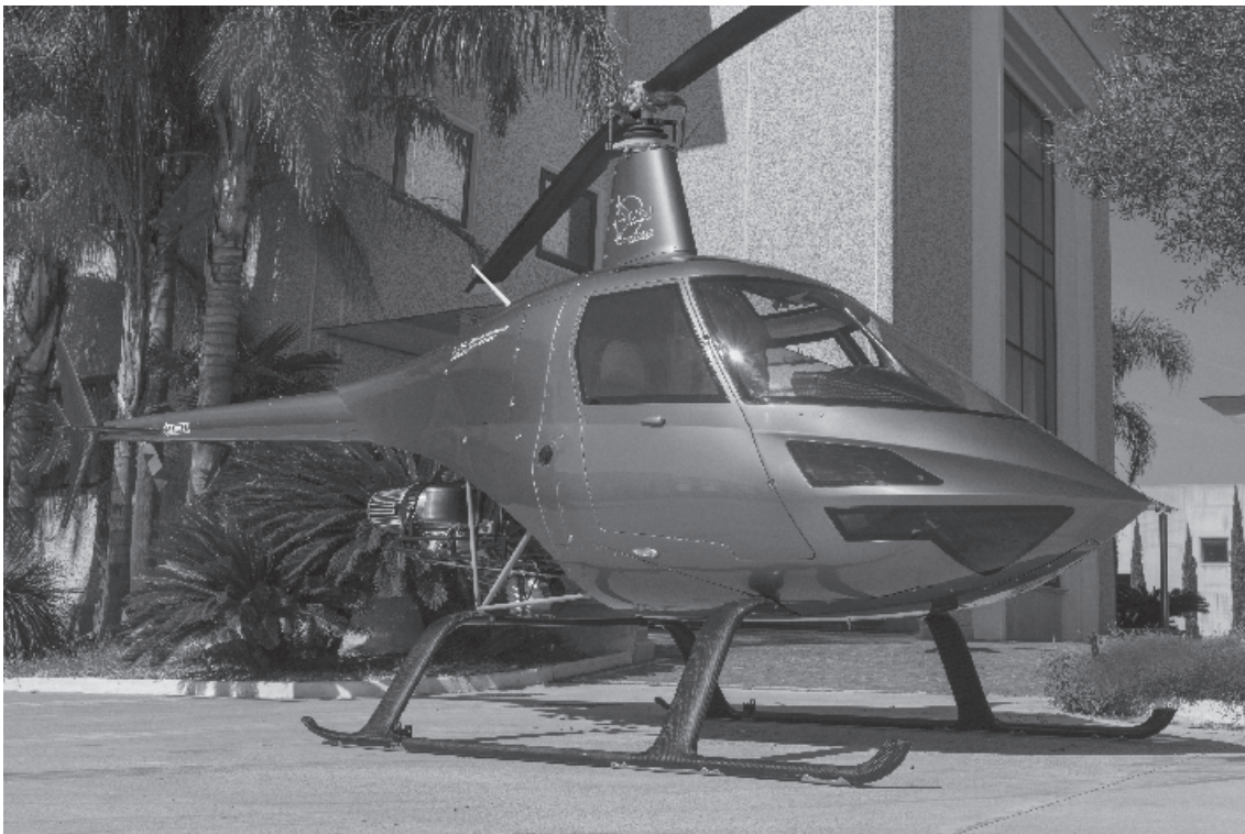
Vrtulník T250 italské firmy I.R.I. Vrtulník s turbohřídelovým motorem TS100 T250 helicopter of Italian I.R.I. Helicopters with the TS100 turboshaft engine
